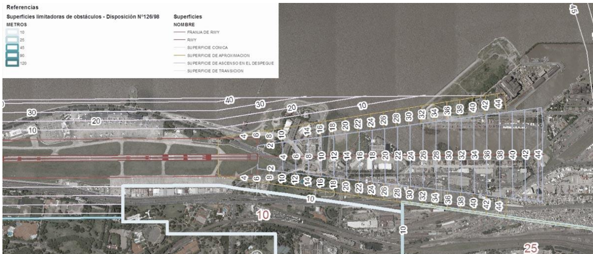
Cono de aproximación Aeroparque Jorge Newbery. Fuente: Elaboración propia con información de Bases del Concurso
